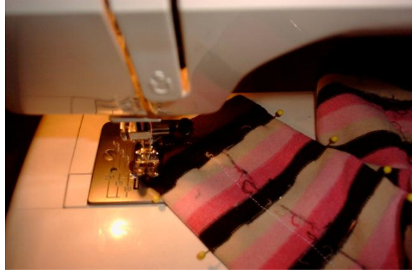
Resim 2.65: Çorabın lastik kısmını yuvarlatarak dikiş.
